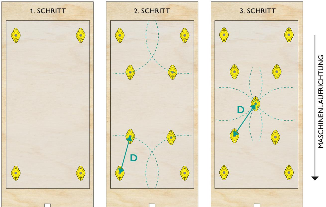
1. Nach Möglichkeit wie möglich in allen 4 Ecken je einen CITO SECURE PRESSER setzen.
